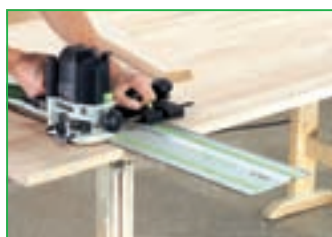
Fräsen von Gratleisten oder schrägen Nuten: mit dem Führungssystem kein Problem.
