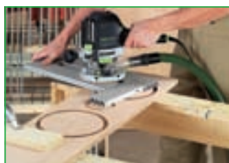
Kreise einfach Fräsen: Radius einstellen, OF 1400 mit Kopierring aufsetzen.
