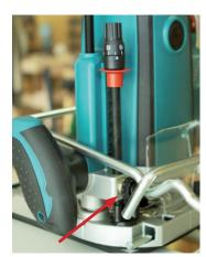
Wird er um 180° gedreht montiert verdeckt er den Revolveranschlag der Tiefeneinstellung.
