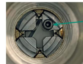
Schauen Sie durch die Rückseite des Spannfutters, um die Schraube zu sehen. Zum Entfernen der Montagebacken zuerst die Sicherungsschraube entfernen. **A**
