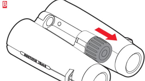
Ziehen Sie nun das Rad der Zentraffokussierung in Okularrichtung heraus (Bild **B**).
