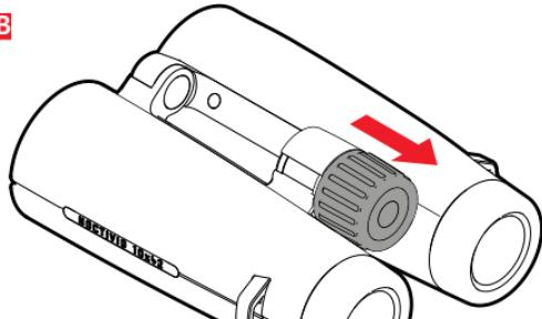
Sbloccare ora la manopola di messa a fuoco tirandola in direzione dell'oculare (figura **B**). Quindi, mettere a fuoco lo stesso oggetto usato precedentemente per l'occhio sinistro solo per l'occhio destro. Premendo in direzione dell'obiettivo, la correzione della messa a fuoco diottrica viene nuovamente bloccata e memorizzata per le successive osservazioni. È anche possibile leggere la regolazione diottrica personale impostata sulla finestra di visualizzazione sulla manopola di messa a fuoco.
