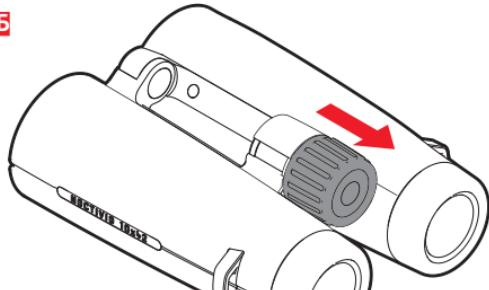
Теперь высвободите колесико фокусировки, потянув его в направлении окуляра (рис. Б). Настройте резкость правым глазом, направив бинокль на тот же объект. Нажатием на кольцо настройки диоптрий в направлении объектива оно снова фиксируется и сохраняется для последующего наблюдения. Ваша собственная, индивидуальная настройка диоптрий будет указана в окошке на кнопке фокусировки.
