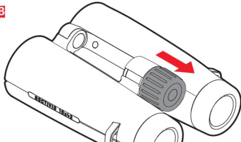
Bloquez alors la molette de mise au point en la tirant en direction de l'oculaire (figure **B**). Faites la mise au point seulement avec l'œil droit sur le même objet comme auparavant. En appuyant en direction de l'objectif, la correction dioptrique s'enclenche et elle est alors en position bloquée pour d'autres observations. Vous pouvez consulter votre réglage individuel de correction dioptrique dans la fenêtre du bouton de mise au point.
