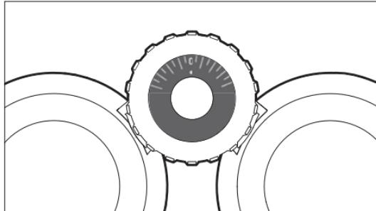
Ontgrendel het scherpstelweltje uitsluitend door het in oculairrichting eruit te trekken (afbeelding B). Stel op hetzelfde object net als hiervoor slechts het rechter oog scherp. Door in de objectief richting te drukken, wordt de dioptrie-scherpstelling weer vergrendeld, en is nu geborgd voor verdere observaties. U kunt uw eigen individuele dioptrie-instelling op het venster op de scherpstelknop aflezen.
